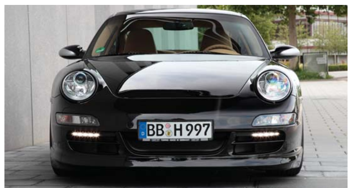
Porsche 997 mit Aerokit I und Tagfahrlichtsystem inkl. Standlichtfunktion Porsche 997 with Aerokit I and daytime running light system with parking light function
