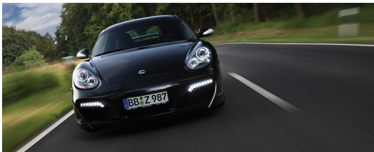
Porsche Cayman S mit TECHART Aerokit II und multifunktionalem Tagfahrlichtsystem. 9 LEDs mit automatischer Leuchtstärkenregulierung sowie 4 LED-Blinkleuchten sorgen für mehr aktive Sicherheit Porsche Cayman S with TECHART Aerokit II and multifunctional daytime running light system. 9 LEDs with automatic brightness adjustment and 4 indicator LEDs provide more active safety
