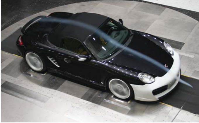
Erprobung der aerodynamischen Komponenten im Windkanal Wind tunnel testing of the aerodynamic components
