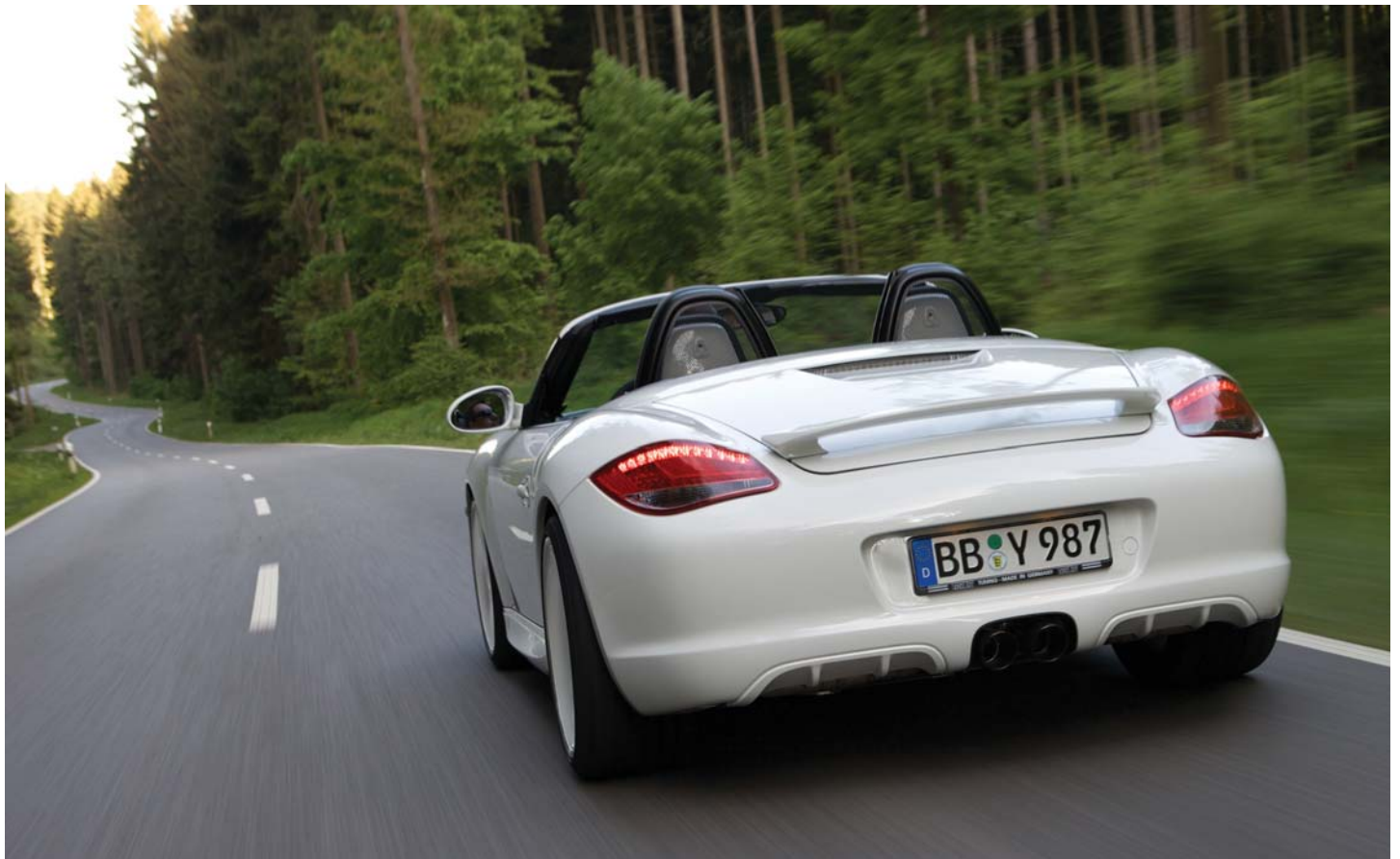
TECHART Heckspoiler I, Seitenschweller Sportendrohre und Formula Räder in Wagenfarbe fügen sich nahtlos in das Erscheinungsbild des Porsche Boxsters ab Modelljahr 2009 ein The TECHART rear spoiler I, side skirts, sport tailpipes and Formula wheels integrate seamlessly with the exterior design of the model year 2009 Porsche Boxster
