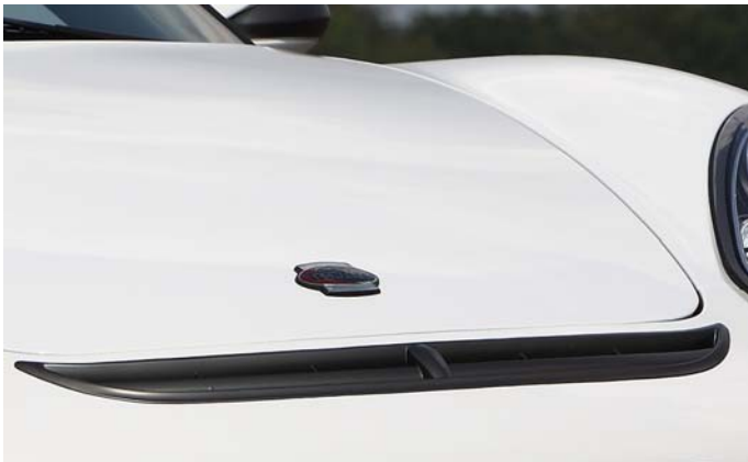
Luftauslass an der Frontverkleidung in schwarz Air vent at the front apron in black
