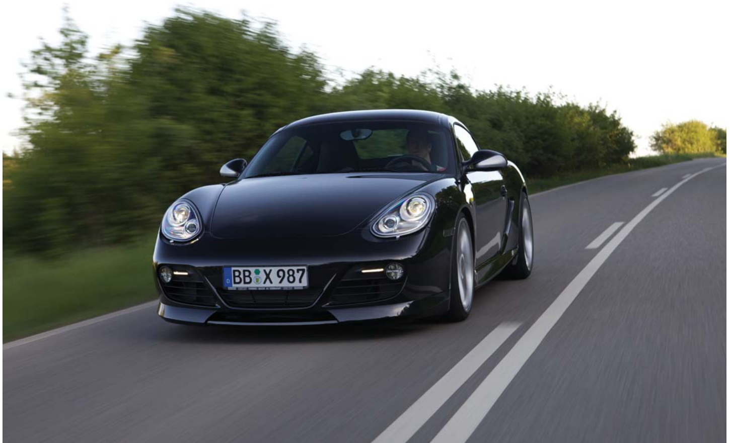
TECHART Aerodynamik Kit I für den Porsche Cayman ab Modelljahr 2009 mit Frontspoiler I, Seitenschweller und Heckspoiler I in Wagenfarbe. Außenspiegelzierblenden in silber. TECHART Aerodynamic kit I for the Porsche Cayman from model year 2009 with front spoiler I, side skirts and rear spoiler I in body color. Side mirror trims in silver.
