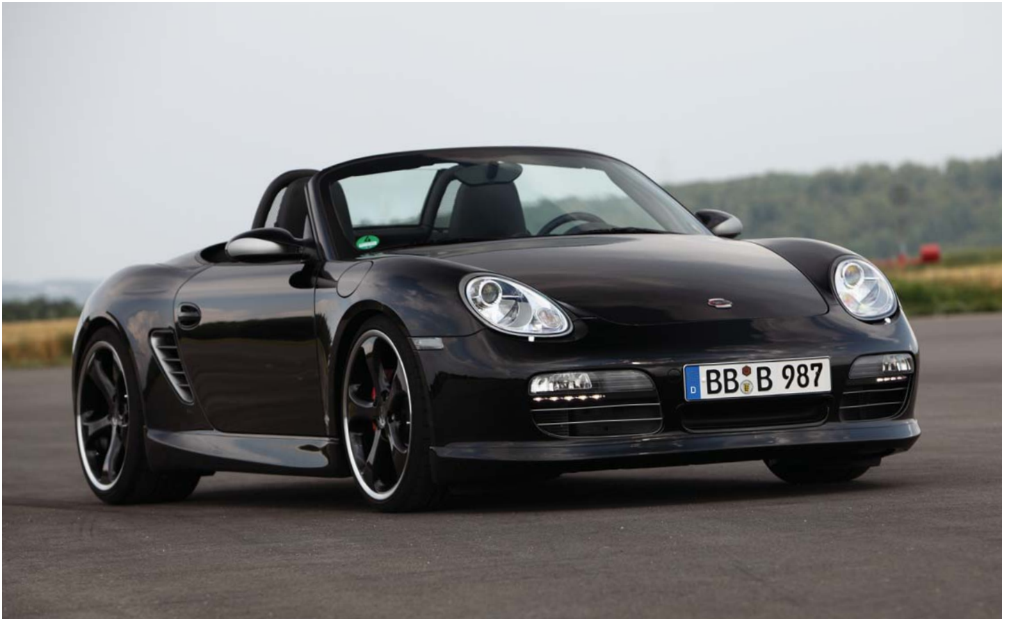
Das TECHART Tagfahrlichtsystem mit 5 LEDs für die Porsche Boxster und Cayman Modelle bis Modelljahr 2008 The TECHART daytime running light system with 5 LEDs for Porsche Boxster and Cayman models up to model year 2008
