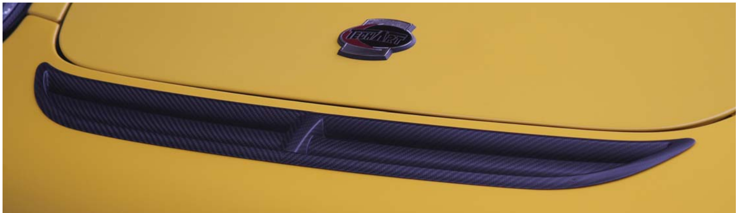
Luftauslass an der Frontverkleidung in Kohlefaser Air vent at the front apron in carbon fiber
