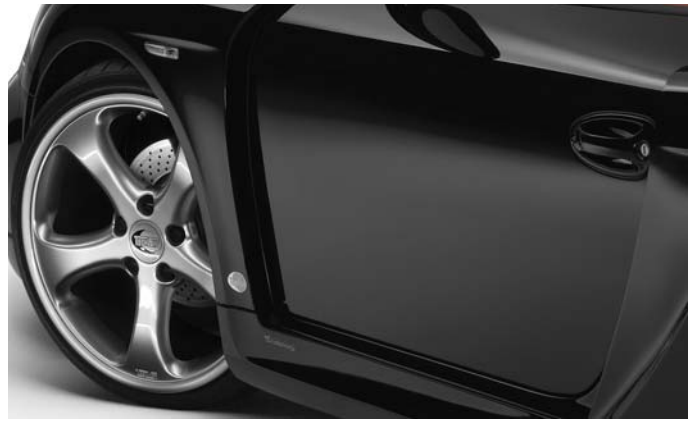
Widebody Kotflügelverbreiterungen vorn und hinten Widebody front and rear fender extensions
