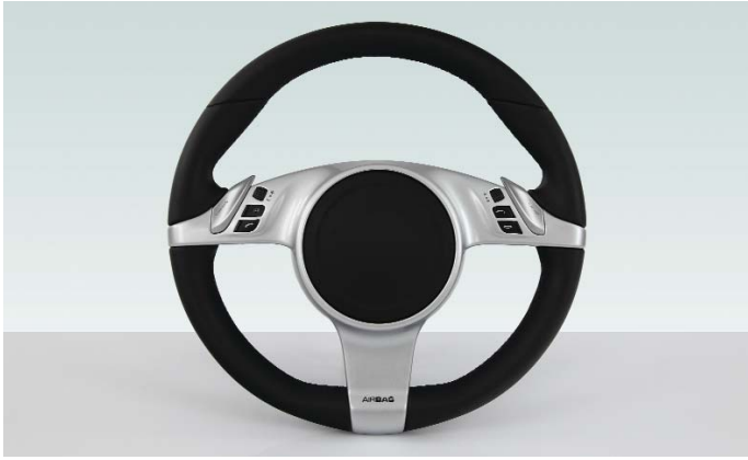
Original Lenkrad mit standard PDK-Schiebetasten vor der Umrüstung OE steering wheel with standard PDK gearshift switches before modification
