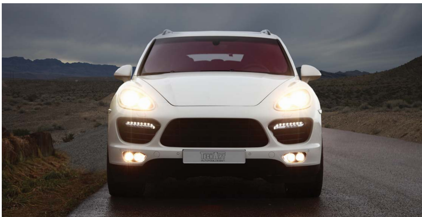
Die TECHART Tagfahrlichtsysteme mit 9 LEDs für die Porsche Cayenne Modelle ab Modelljahr 2011 The TECHART daytime running light system with 9 LEDs for Porsche Cayenne models from model year 2011
